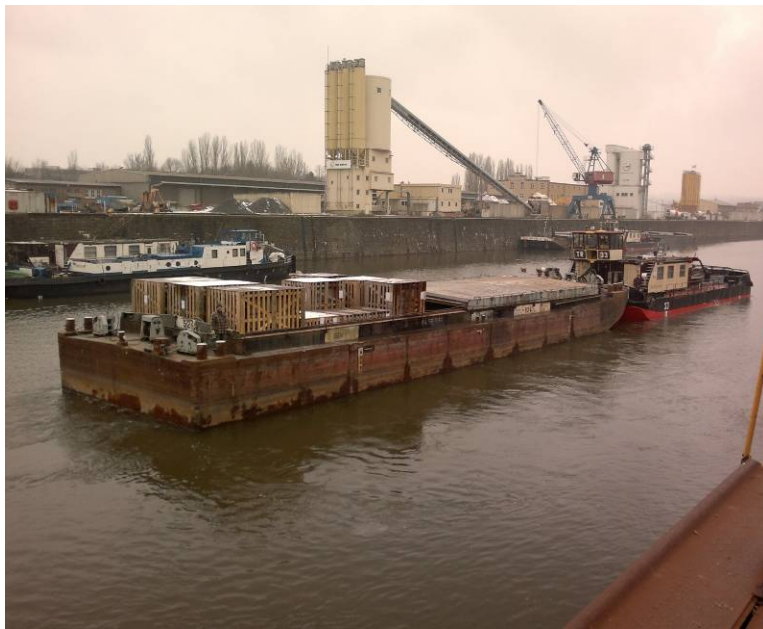
Transport von Transformatoren per Binnenschiff (Foto: Imperial)
