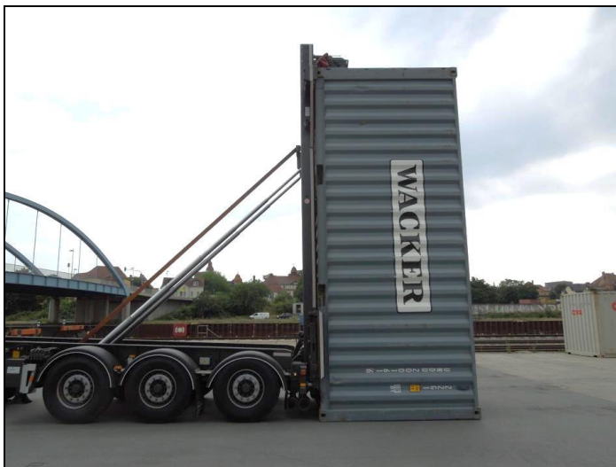
Aufstellen eines Containers (Foto: SBO)
